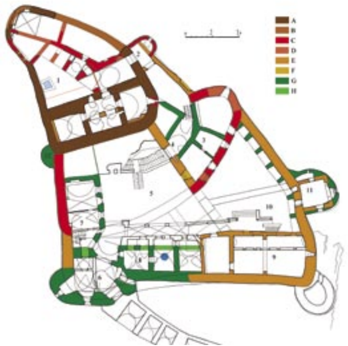
Obr. 154. Stavebné fázy hradu Nedeca po prestavbe v 16. a 17. storočí: a) zachované múry prvej fázy, b) nezachované múry prvej fázy, c) zachované múry prvej gotickej prestavby, d) nezachované múry prvej gotickej prestavby, e) zachované múry druhej gotickej prestavby, f) nezachované múry druhej gotickej prestavby, g) zachované múry z prelomu 16. a 17. storočia, h) nezachované múry z prelomu 16. a 17. storočia. 1 – horný hrad, 2 – brána a predbránie horného hradu, 3 – stredný hrad, 4 – brána a hala stredného hradu, 5 – dvor dolného hradu, 6 – vysunutá veža s bránou, 7 – hospodárska budova pri severnom múre spájajúcom veže (kurtina), 8 – hospodárska budova so studňou pri západnej kurtine, 9 – prebudovaný obytný priestor, 10 – pivnica pod dvorom (prebudovaná z pôvodnej vjazdovej haly), 11 – južná bašta (prebudovaná z gotickej obrannej bašty), 12 – malá bašta zo severu („baštka“). Podľa Piotr Stępień na základe merania J. Polaka z roku 1949.
